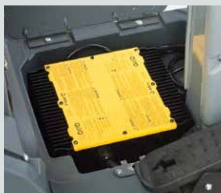
Integrert innbygd lader gjør det enkelt å lade batteriet ved et hvert strømuttak.
