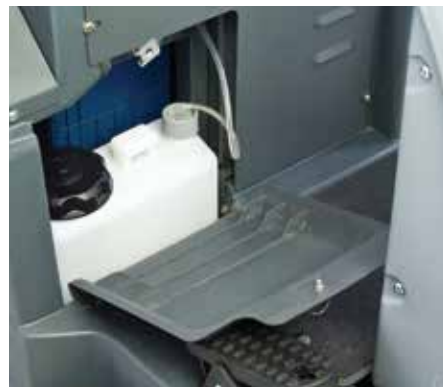
Grovfilteret fanger opp smuss fra sugeslangen og forhindrer det i å nå til skittenvannstanken.
